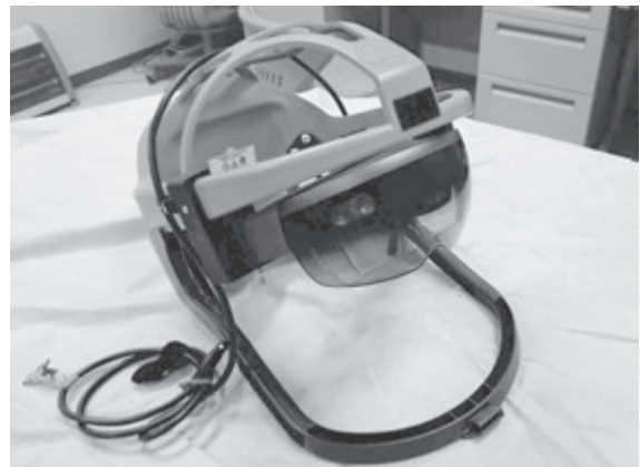
人工関節手術用フードに装着した Microsoft HoloLens
